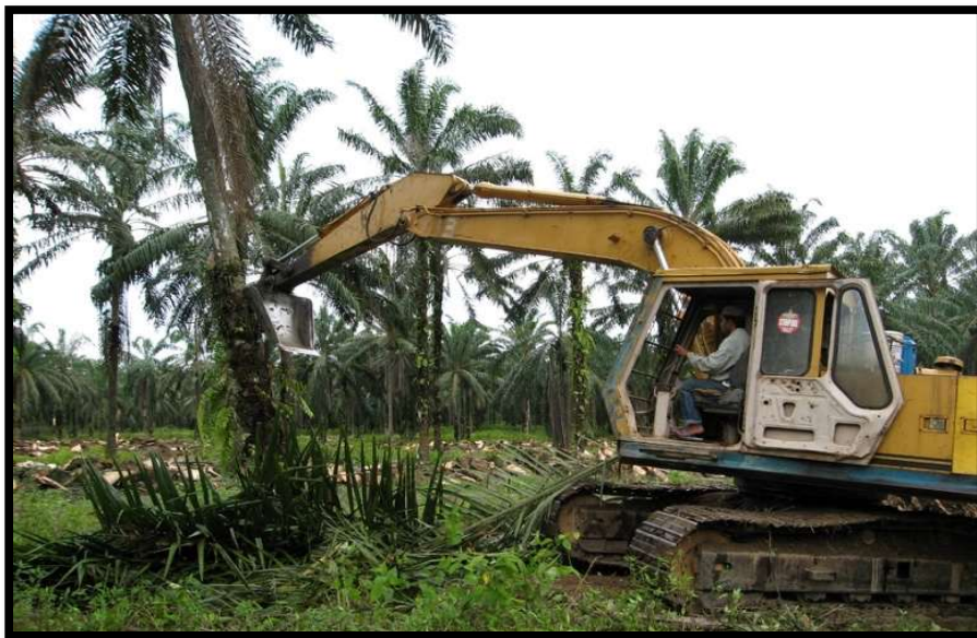
Gambar 1: Menolak dan menumbang pokok sawit dengan jentera
